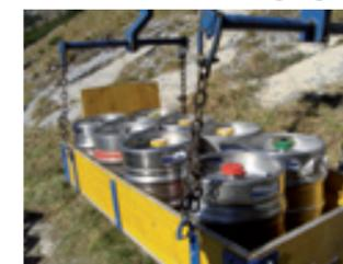
Die etwa 3.000 Meter lange Materialseilbahn führt vom Rißtal (Talstation bei der Kaiserhütte) zur Tölzer Hütte. Sie versorgt die Hütte mit Lebensmitteln, Getränken, Holz, Gasflaschen und anderen Gütern. Der Antrieb erfolgt durch einen Dieselmotor, der auch als Notstromaggregat eingesetzt werden kann.
